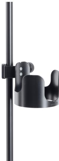
Stabiler Halter aus Metall zum Abstellen von Flaschen, Gläsern und Tassen mit einem Durchmesser von max. 85 mm. Die Höhe des Korpus beträgt 80 mm und das Gewicht liegt bei ca. 270 Gramm. Die oberflächenschonende Klemmung ist für Stative mit einem Rohrdurchmesser bis 30 mm geeignet. anschaubar bis: 30 mm Ausführung: schwarz EAN: 4016842119516 Gewicht: 0,27 kg Höhe: 80 mm Material: Stahl passend für: Flaschen, Gläser und Tassen mit max.  $\varnothing$  85 mm
