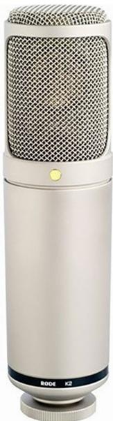
Preisgekröntes Class A Röhrenmikrofon mit handselektierter Twin-Trioden Röhre 6922. Richtcharakteristik am externen Netzteil stufenlos regelbar. Extrem niedriges Eigenrauschen (10 dBA), hoher Grenzschalldruck (162 dB). Inkl. Koffer, elastische Aufhängung, Netzteil und Verbindungskabel (10 m).
