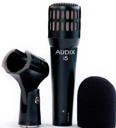
i5 steht für eine akkurate und sehr natürlich Klang-Reproduktion dank einer dynamischen Kapsel in Nieren-Charakteristik und einer VLM-Membran vom Typ B. Da dieses Universal-Mikrofon Schalldrücke von bis zu einem Pegel von 140 dB verzerrungsfrei verarbeiten kann und das über einen Übertragungsbereich von 50 Hz bis 16 kHz, ist es die erste Wahl wenn es um die Abnahme von Snare-Drum, Percussion, E-Gitarren- und E-Bass-Cabinets/Combos, diverse Akustik-Instrumente oder auch um reine Sprache geht.
