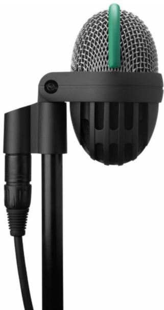
Das AKG D112 MKII ist ein dynamisches Großmembranmikrofon für Bassdrum und Bass. Es verarbeitet verzerrungsfrei Schalldruckpegel bis 160 dB. Die Großmembrankapsel sorgt für eine druckvolle Übertragung tiefer Frequenzen unter 100 Hz. Für den nötigen Punch wurde die Frequenz bei 4 kHz leicht angehoben. Auch ohne zusätzlichen EQ setzt sich das AKG D112 MKII selbst im dichtesten Mix durch.
