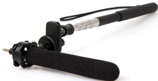
MicW Kamera-Mikrofon ISHTGUN - inkl. Zubehör-Set Mikrofontyp Interferenzröhre Richtcharakteristik Spezial Superniere Kapsel  $\varnothing$  8,5 mm Übertragungsbereich 100 - 18.000 Hz max. Schalldruck dB Empfindlichkeit 8 mV/Pa Signal/Rauschabstand (Ref. 1Pa A-gewichtet) 65 dB Geräuschpegel (IEC 268-4 A-gewichtet) 28 dB Ausgangsimpedanz Spannungsversorgung Plug & Play Anschluss 4-pol Mini-Klinke Abmessungen  $\varnothing$  x L 8-10 x 120 mm (ohne Stecker) Gewicht 20 g Farbe schwarz
