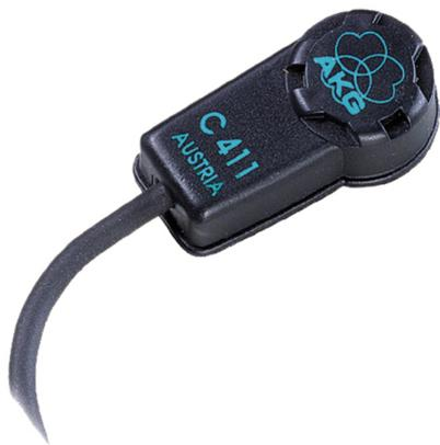
AKG C411 PP - für alle drahtgebundenen Anwendungen bei verfügbarer Phantomspeisung oder Batteriespeisung (Standard-XLR). Kondensatormikrofon zur Abnahme akustischer Saiteninstrumente. Das AKG C411 PP benötigt eine Stromversorgung (Phantomspeisung) von 9 -- 52 Volt. Über den XLR-Stecker lässt es sich an den Mikrofon-Eingang des Mischpultes oder an ein Phantomspeisegerät anschließen. Das Anschlusskabel ist 3 m lang. Kabel mit fest verlötetem Phantomspeiseadapter.
